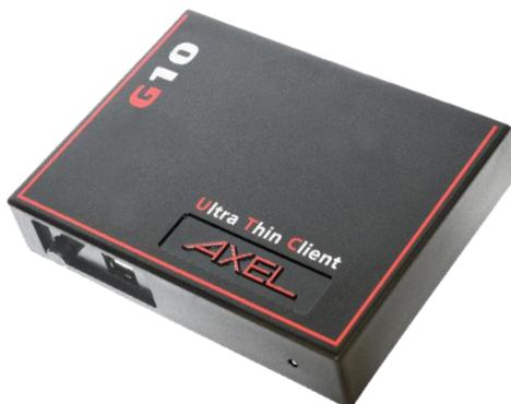
Conçu et fabriqué par AXEL, le client léger G10 intègre la technologie « **Ultra Thin Client** » sans BIOS ni OS.
